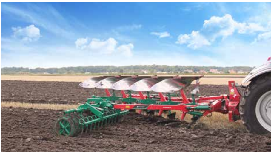
Раскомат можно установить на плуге 2500 i-Plough от Kverneland, который имеет до 5 отвалов
