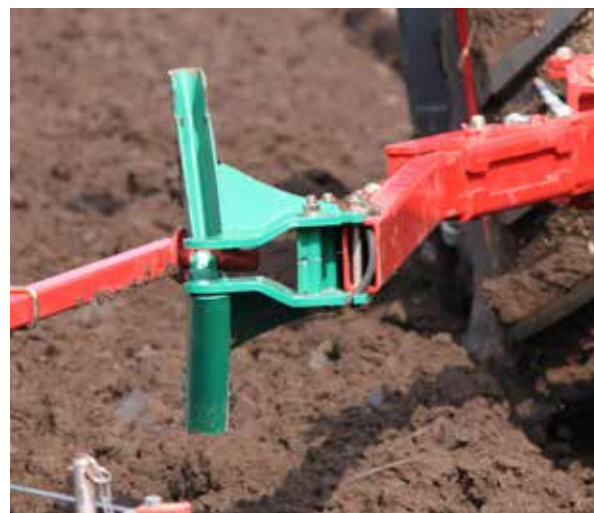
Почвоуплотнительный каток, соединенный с почвоуплотнителем
